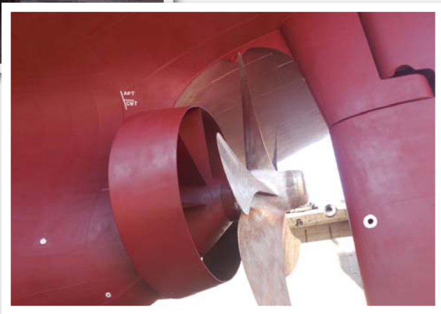
貨輪導流罩安裝情形
